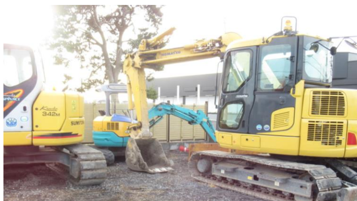
大型重機で小型重機を囲み、上方を塞ぐ
